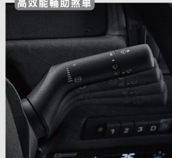
結合引擎減速器與油壓減速器，提供4段式輔助煞車功能，提升煞車效能、減低駕駛風險。
